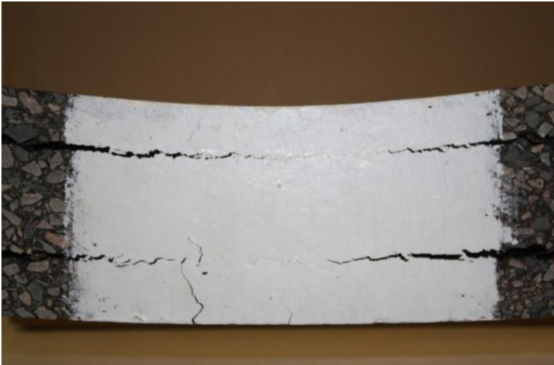
Figure i32. Etat de fissuration après 5 jours en flexion post-essai 4PB
