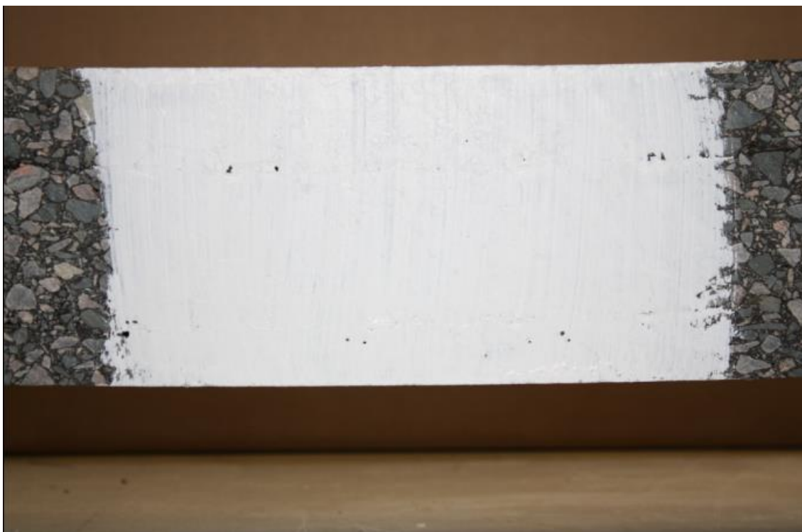
Figure 4.28 Etat de fissuration à 0 h de flexion de la poutre 20R, post-essai de fatigue à \epsilon = 115 \mu\text{m/m}
