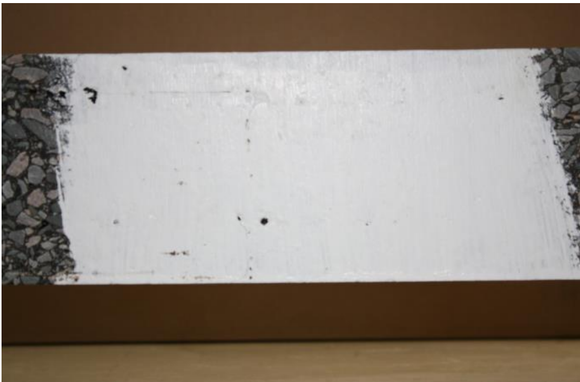
Figure i11. Etat de fissuration à 0h en flexion post-essai 4PB
