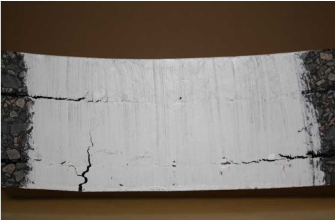
Figure i37. Etat de fissuration après 34h (1 jour + 10 h) en flexion post-essai 4PB
