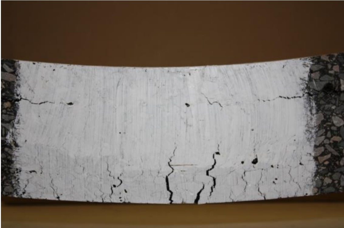
Figure i24. Etat de fissuration après 10 jours en flexion post-essai 4PB
