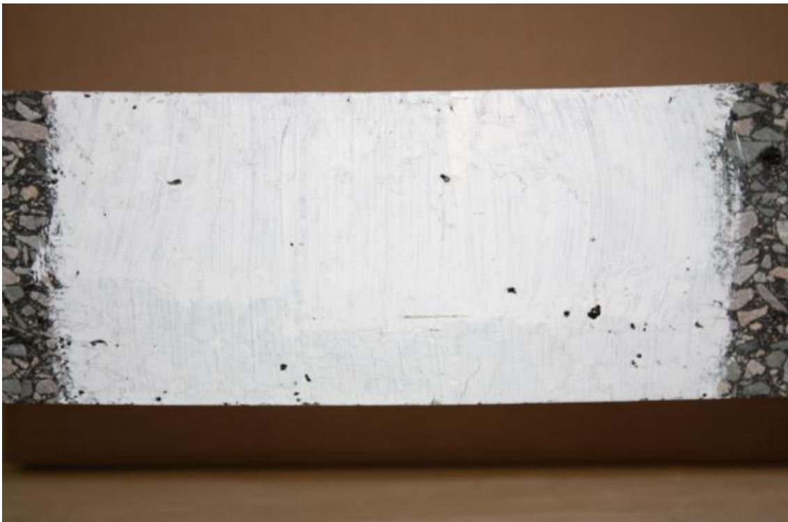
Figure i17. Etat de fissuration après 24h (1jour) en flexion post-essai 4PB
