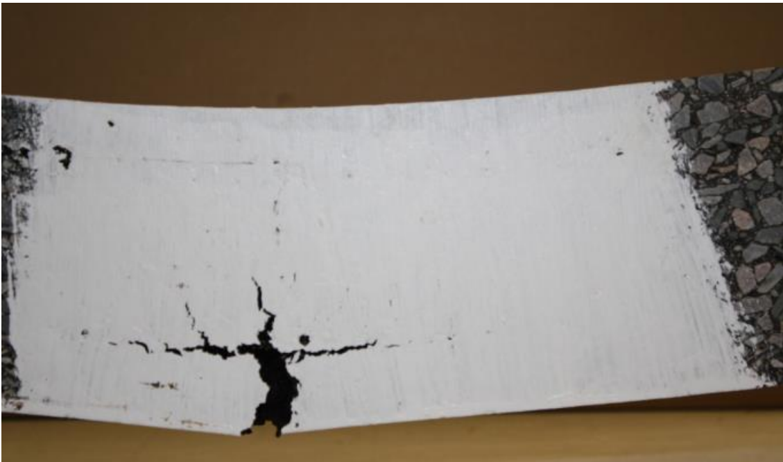
Figure i15. Etat de fissuration après 82h (3 jours+10h) en flexion post-essai 4PB
