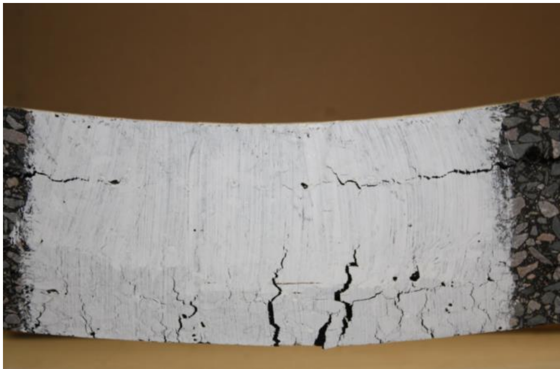
Figure i25. Etat de fissuration après 10 jours + 6 h en flexion post-essai 4PB
