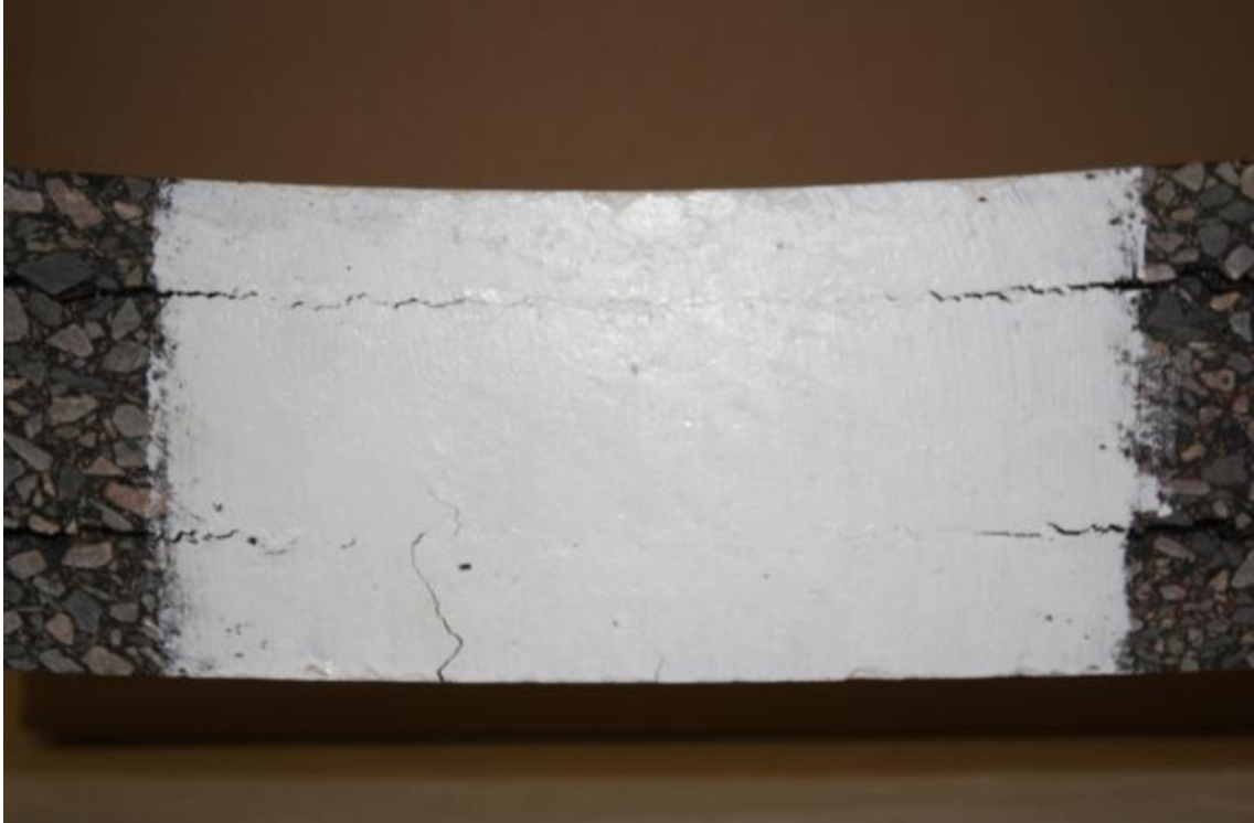
Figure i30. Etat de fissuration après 3 jours en flexion post-essai 4PB
