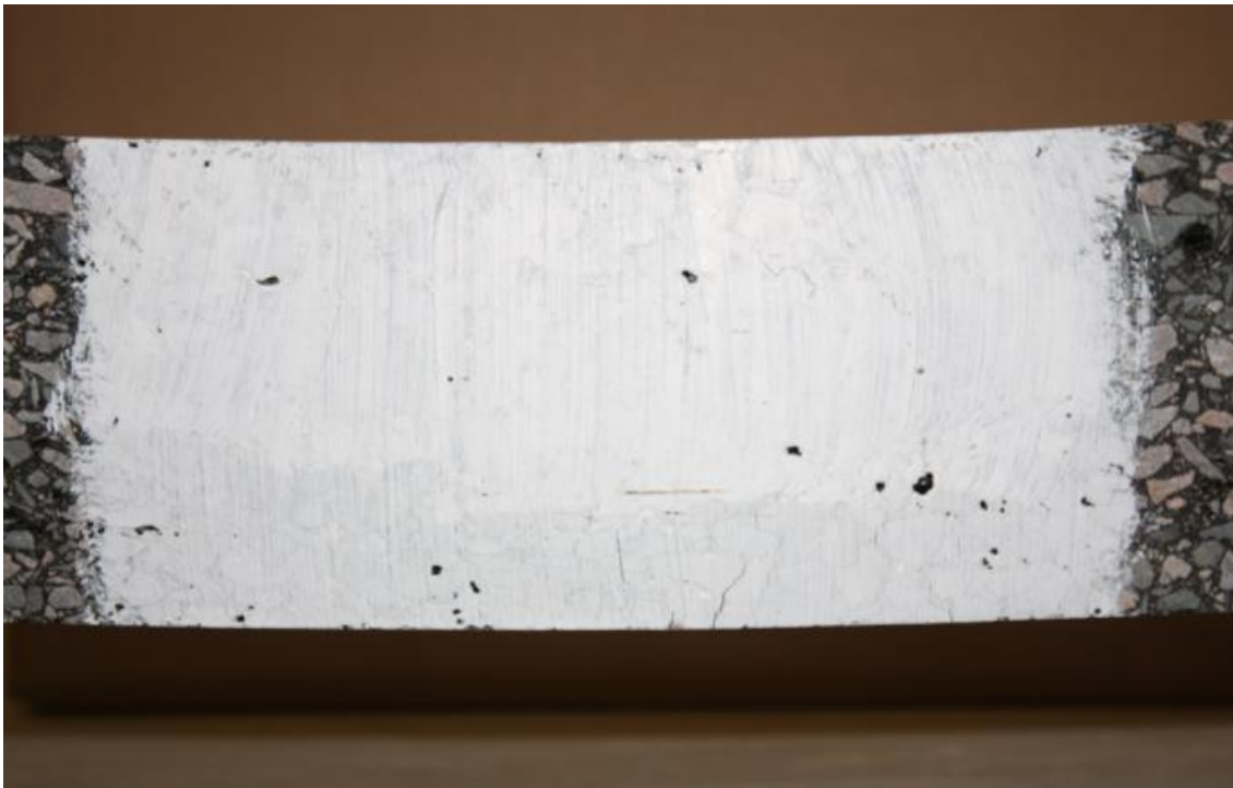
Figure i19. Etat de fissuration après 72h (3jours) en flexion post-essai 4PB
