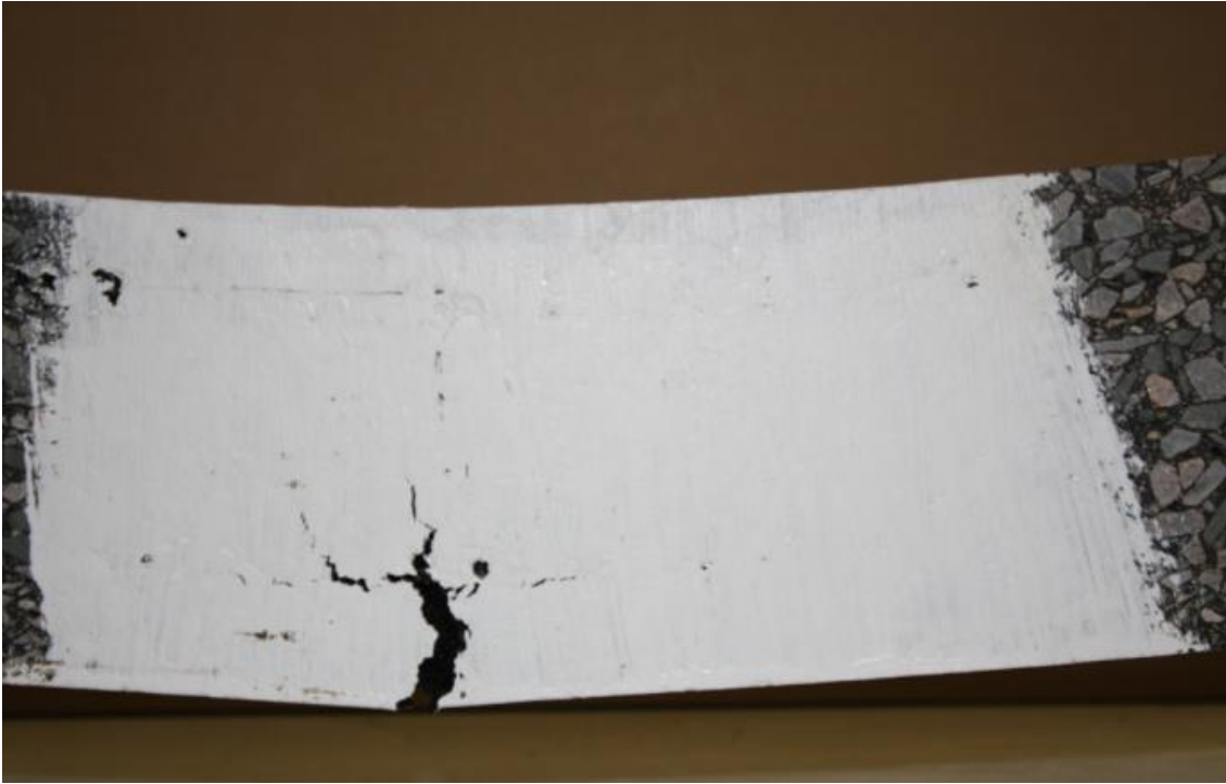
Figure i14. Etat de fissuration après 72h (3 jours) en flexion post-essai 4PB
