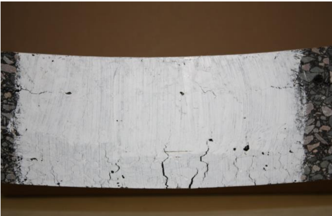
Figure i23. Etat de fissuration après 9 jours en flexion post-essai 4PB
