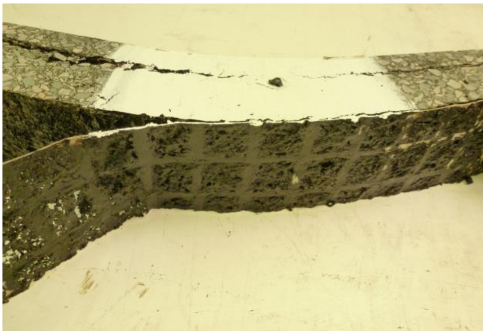
Figure 4.35 Récupération de la géo-grille après la flexion post essai de fatigue
