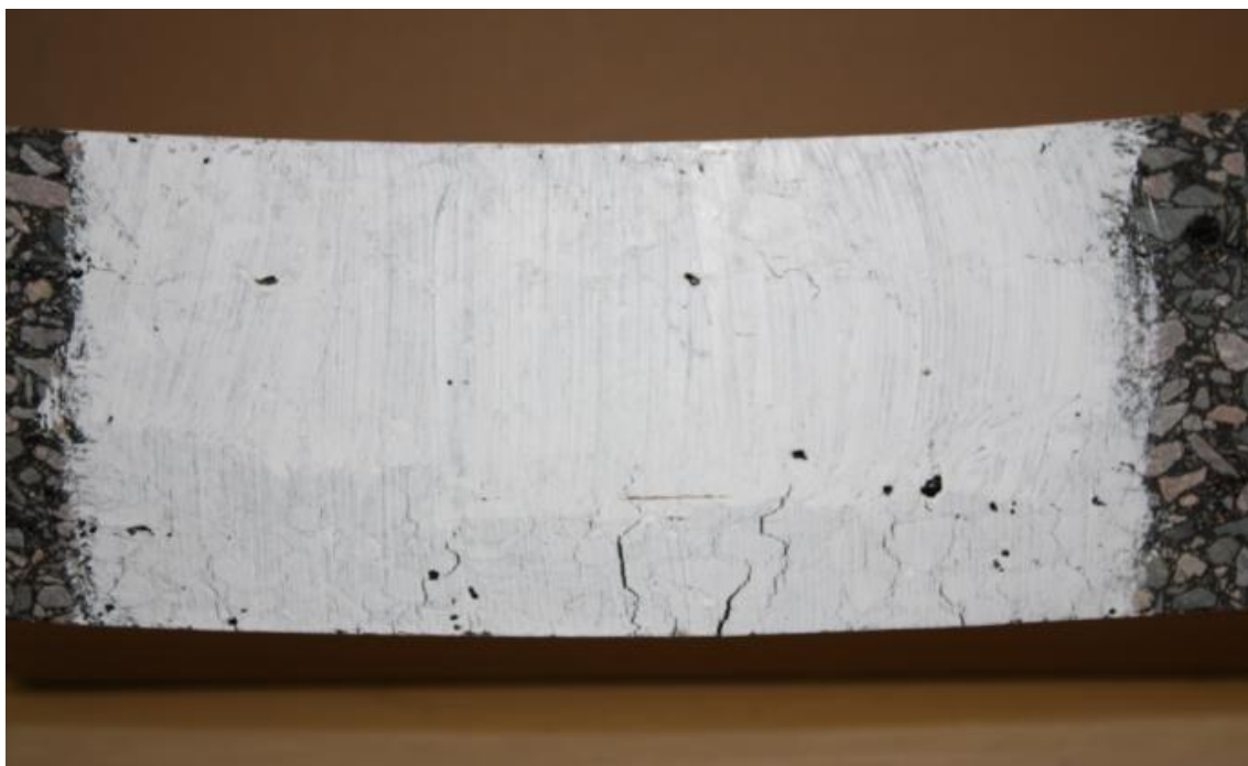
Figure i21. Etat de fissuration après 7 jours en flexion post-essai 4PB
