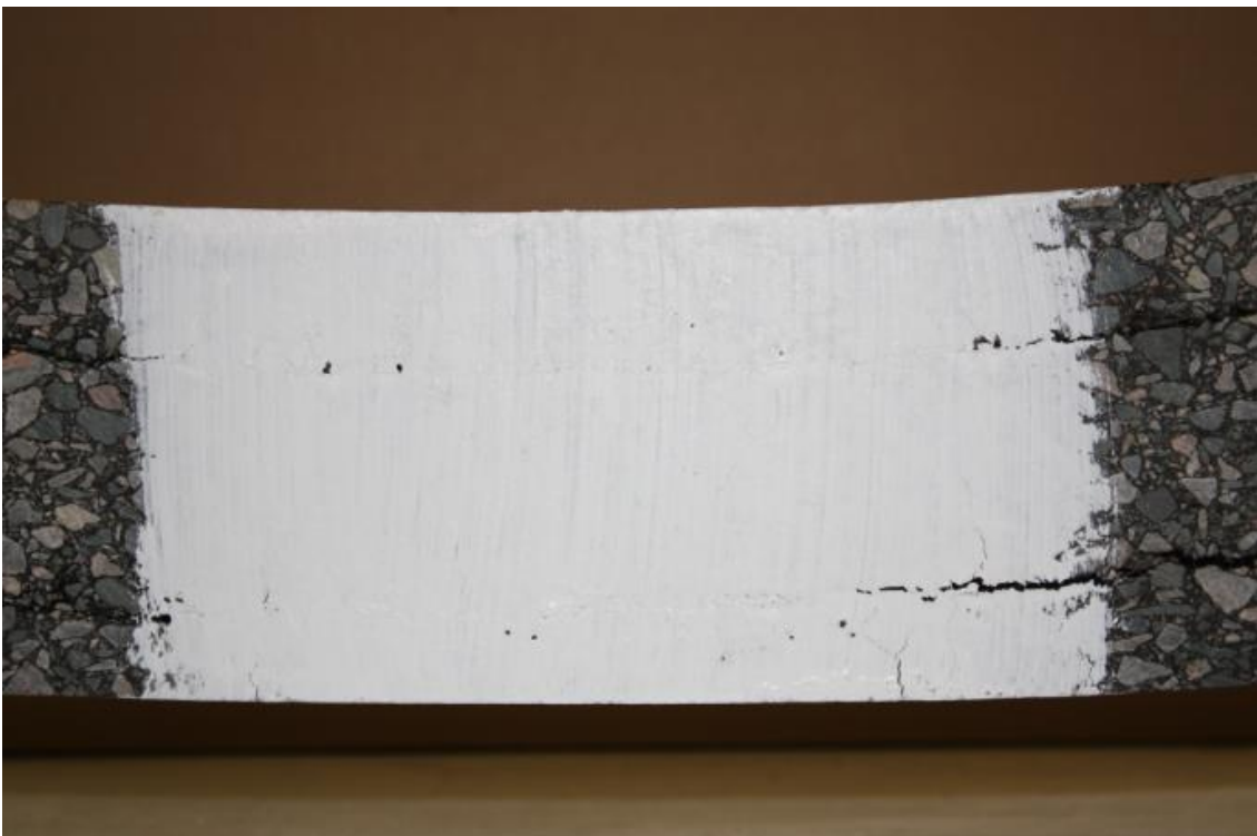
Figure i3. Etat de fissuration après 24h en flexion post-essai 4PB
