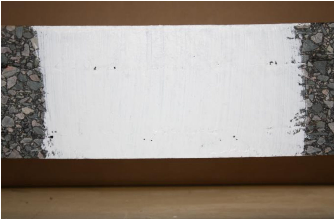
Figure i1. Etat de fissuration à 0 h en flexion post-essai 4PB
