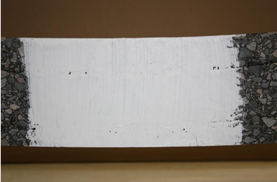
Figure i2. Etat de fissuration après 5h en flexion post-essai 4PB
