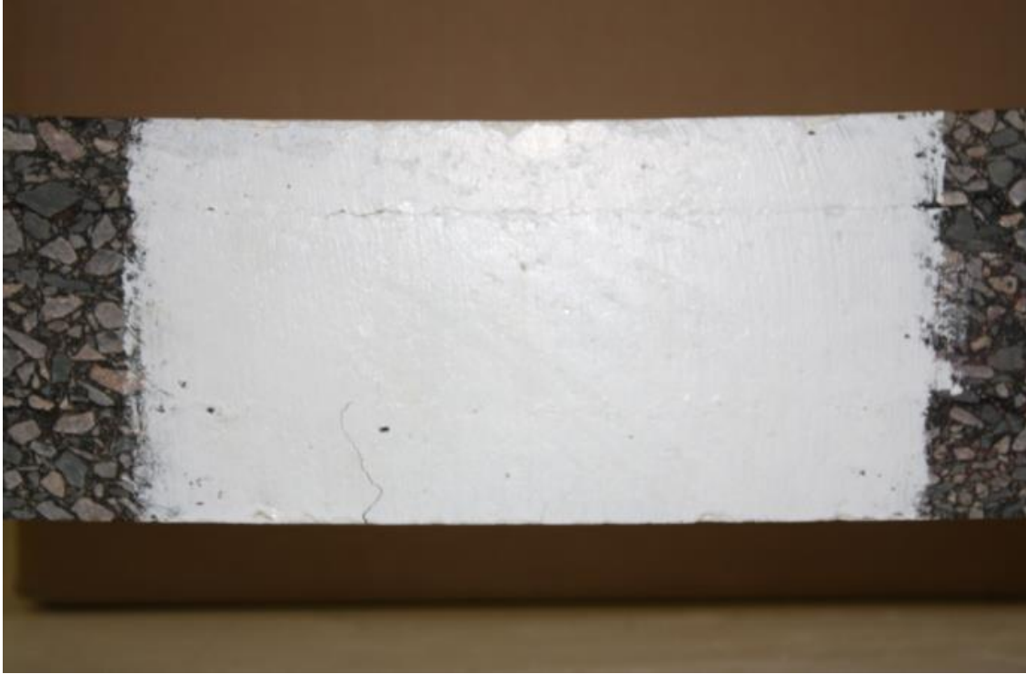
Figure i28. Etat de fissuration après 24h (1 jour) en flexion post-essai 4PB
