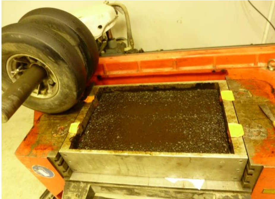
Figure b1. Couche d'émulsion répandue sur la première couche en BBSG
