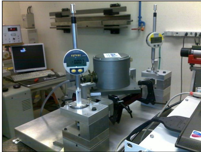
Figure 2-11 : L'inclinomètre Geomechanics 520 lors du test de réception au CERN
