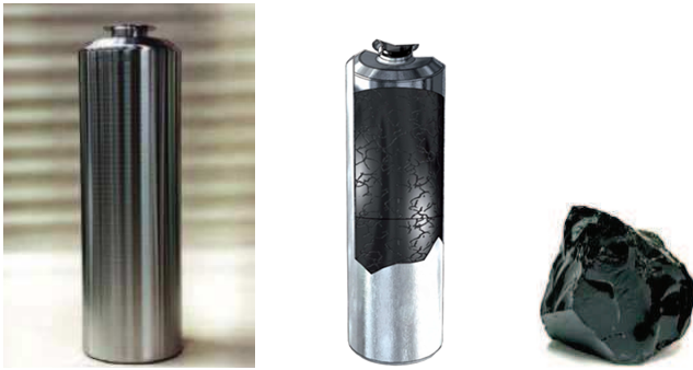
FIG. 1-2 : Colis de déchets vitrifiés CSD-V – photographie, schéma et aspect du verre [GR05, ASN10, MPS+10, And05] (crédits Andra).
