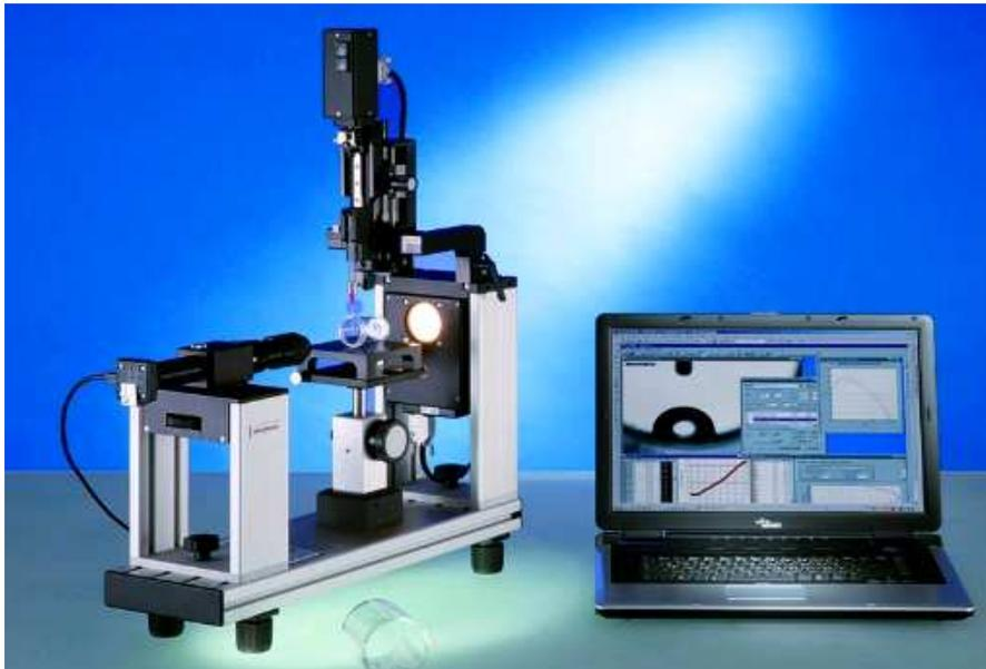
Figure 138 : Equipement de mesure d'angle de contact OCA 15+ (DATAPHYSICS)
