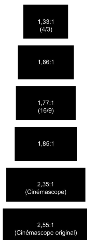
Illustration 9: Les principaux rapports de proportions d'images projetées. Source : Wikimedia, Kyle_the_hacker: http://bit.ly/11xCoEO .
