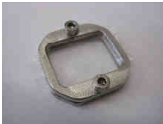
Figure 2.5 : Photographie du dispositif de maintien d'échantillons en PDMS pour la culture cellulaire.
