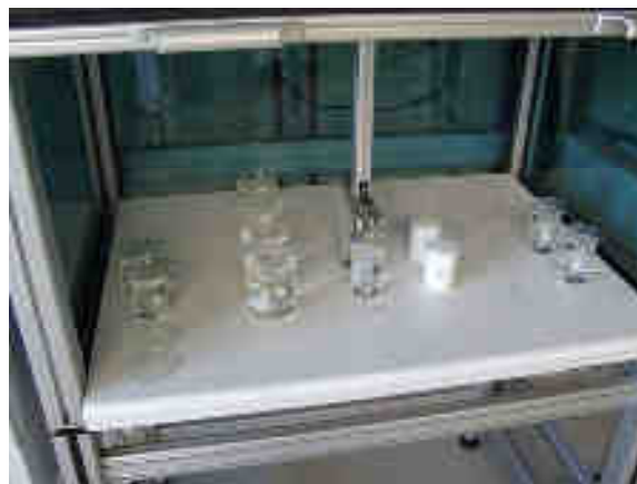
Figure 2.2 : Construction d'un film multicouche à l'aide d'un bras automatisé (Dipping Robot DR3, Kriestein, Allemagne).
