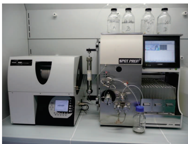
Figure I:24. Système SCPC250 couplé avec un Spot Prep II d'Armen instrument (photo prise au laboratoire)
