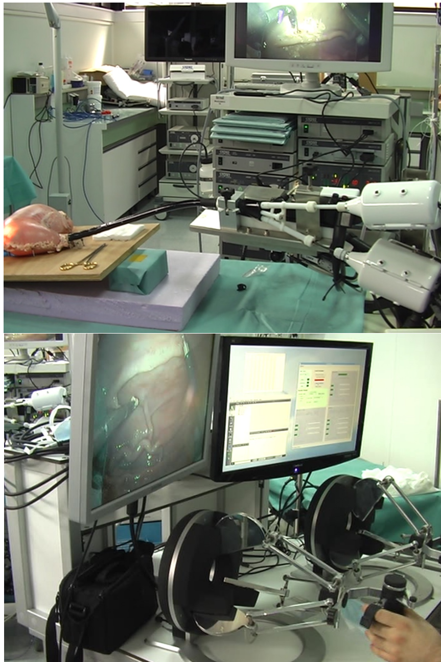
Fig. B.29. Test ex vivo effectué avec STRAS. Haut : le robot est monté sur la table opératoire et un estomac de porc est suturé autour de la tête de l'endoscope. Bas : Poste de travail utilisateur avec les interfaces haptiques, le retour vidéo de la caméra endoscopique et de l'application principale de contrôle.
