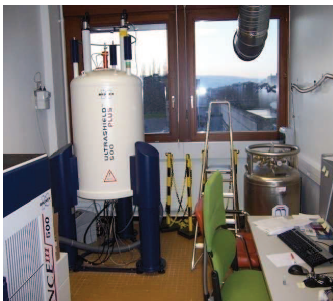
Figure 7. Installation de notre spectromètre BRUKER Avance III (500 MHz)
