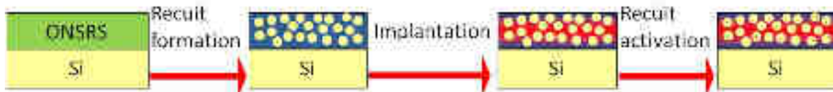
Figure 4.68 : Processus de fabrication des couches d'oxynitride de silicium dopées.
