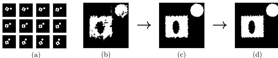
FIGURE 6.16 – Douze des N_{Ref} = 46 images de référence de l'expérience 6.7.4 (a) et résultats de reconstruction à partir des projections bruitées de la Fig. 6.11-a : sans a priori de forme (b), en utilisant la contrainte multi-références avec N = 21 et \alpha = 0.7 (c), puis N = 45 et \alpha = 0.5 (d).
