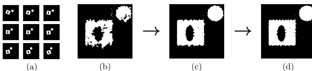
FIGURE 6.17 – Neuf des N_{Ref} = 47 images de référence (a) de l'Exp. 6.7.4, lorsque l'objet modèle appartient à l'ensemble des images de référence. Résultats de reconstruction à partir des projections bruitées de la Fig. 6.11-a : sans a priori de forme (b), en utilisant la contrainte multi-références à l'ordre N = 21 avec \alpha = 0.7 (c), puis à l'ordre N = 45 avec \alpha = 0.5 (d).
