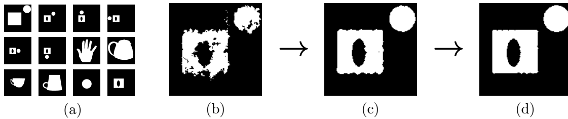
FIGURE 6.15 – Ensemble de N_{Ref} = 12 images de référence (a) de l'Exp. 6.7.3. Résultats de reconstruction à partir des projections bruitées de la Fig. 6.11-a : sans a priori de forme (b), en utilisant la contrainte multi-références à l'ordre N = 21 avec \alpha = 0.9 (c), puis à l'ordre N = 45 avec \alpha = 0.9 (d).
