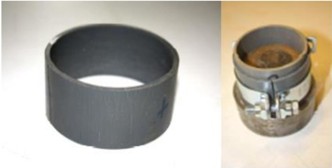
*Figure B.3. Moule de l'échantillon du sable de Missillac*
