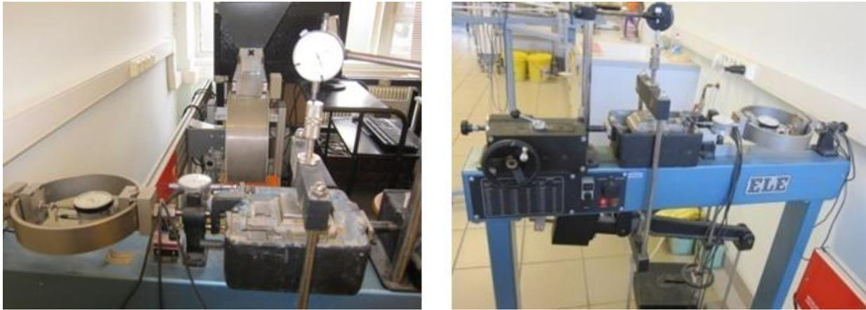
Figure IV.7. Dispositif général d'essai à la boîte de Casagrande
