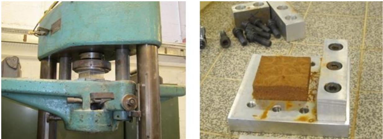
*Figure IV.6. Fabriquer l'échantillon de sable de Missillac*
