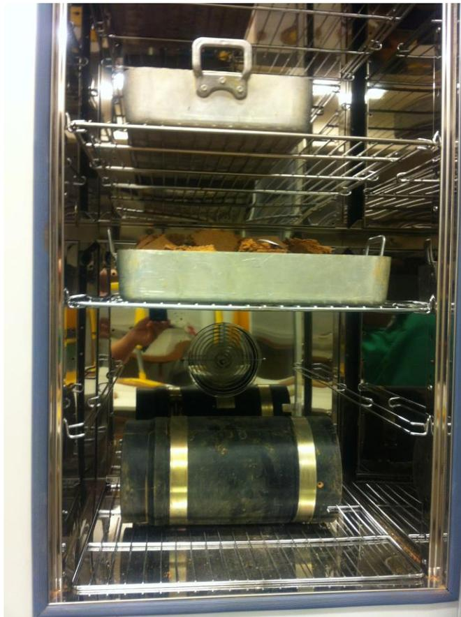
*Figure IV.14. Séchage de l'échantillon*
