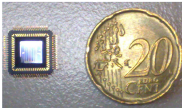
Figure 1.17 – Capteur de gaz à base de CNTFET encapsulé dans un boîtier miniaturisé (encapsulation finale prévue) [39].
