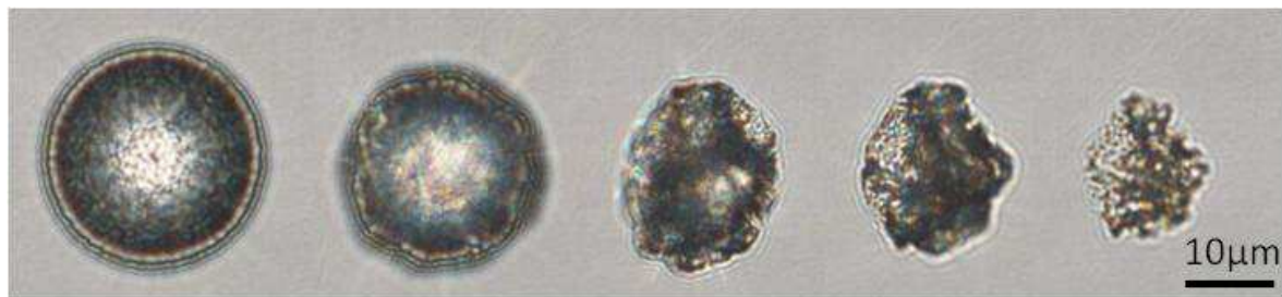
Figure III. 18. Dégonflement d'une bulle dans la solution de F8H11Phos .
