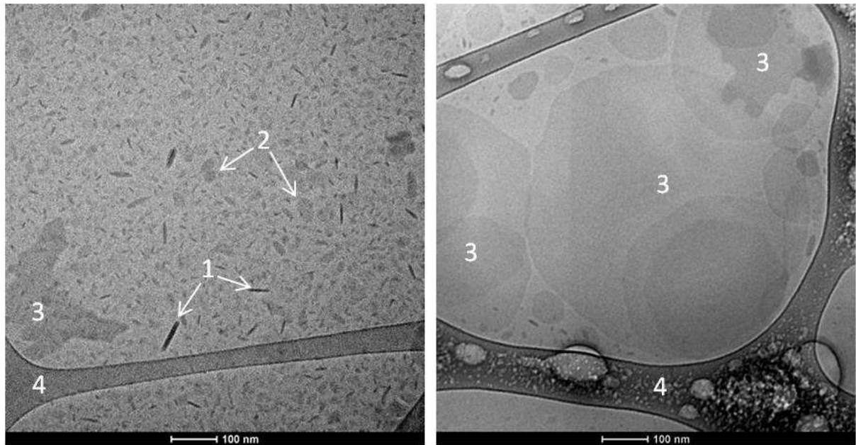
Figure II. 14. Images de cryo-MET des agrégats du F10H2Phos2Na. 1 – petites bicelles vues en tranche, 2 – petites bicelles vues à plat, 3 – grandes bicelles, 4 – grille de cryo-MET.
