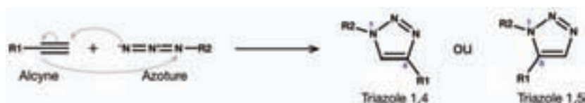
Figure 42 - Réaction de cycloaddition 1,3-dipolaire azoture/alcyne de Huisgen
