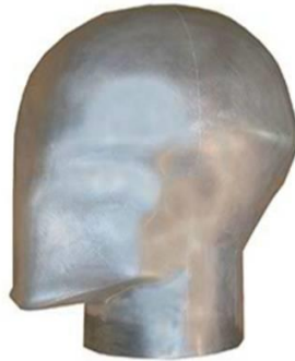
Figure 74. Fausse tête ISO de taille J. Sa masse est de 4.7 kg et sa circonférence de 570 mm
