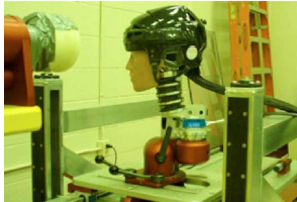
Figure 45. Configuration d'impact latéral sur un casque de hockey (Post et al., 2011)
