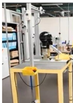
Figure 71. Dispositif permettant de délimiter la zone d'essai et localiser les points d'impact sur le casque. Le pointeur laser est visible à droite de la fausse tête ISO
