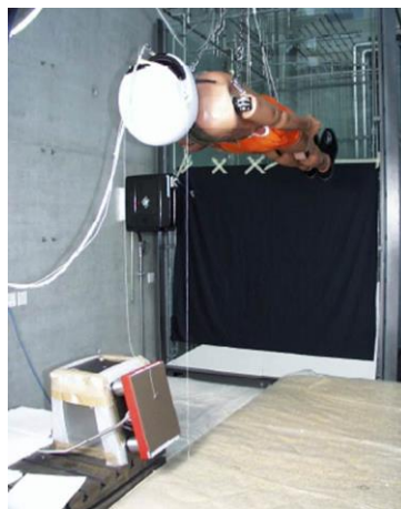
Figure 40. Impact oblique latéral d'un mannequin Hybrid III complet (COST 327)
