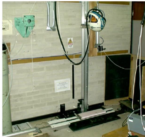
Figure 36. Dispositif expérimental de choc oblique selon Halldin et al. 2001
