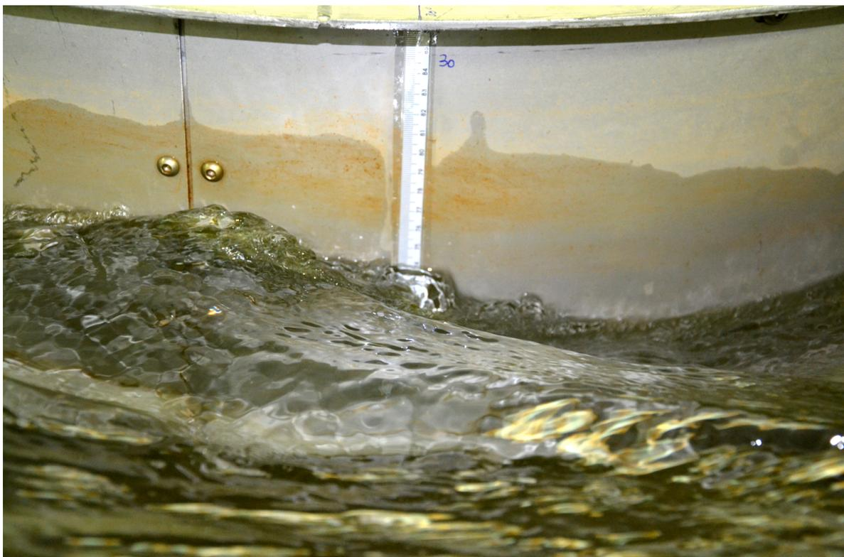
*Figure 74. Photographie de la surface libre pour un débit d'injection de 40 l/s dans le plan 30°*
