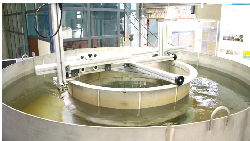
*Figure 72. Photographie de la surface libre pour un débit d'injection de 15 l/s*
