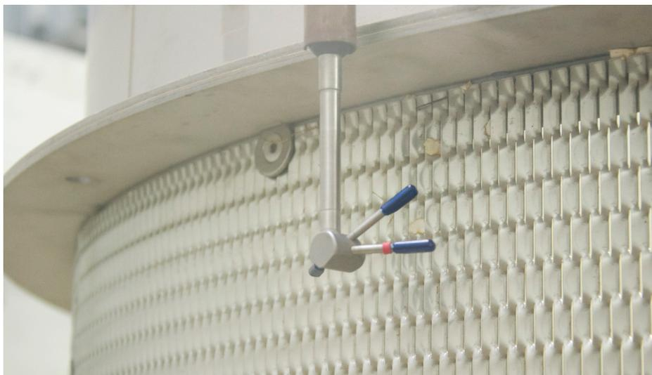
*Figure 81. Photographie de l'ADV à l'amont de la grille (vue isométrique)*
