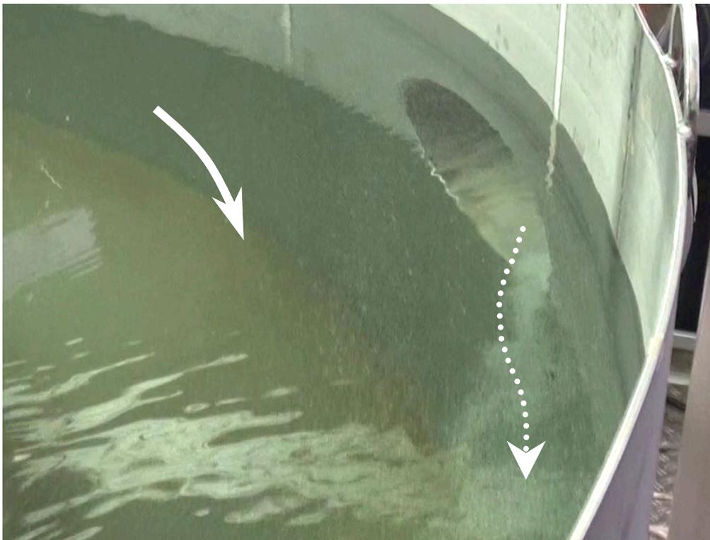
*Figure 92. Comportement des particules de polystyrol blanches en entrée de l'ouvrage*
