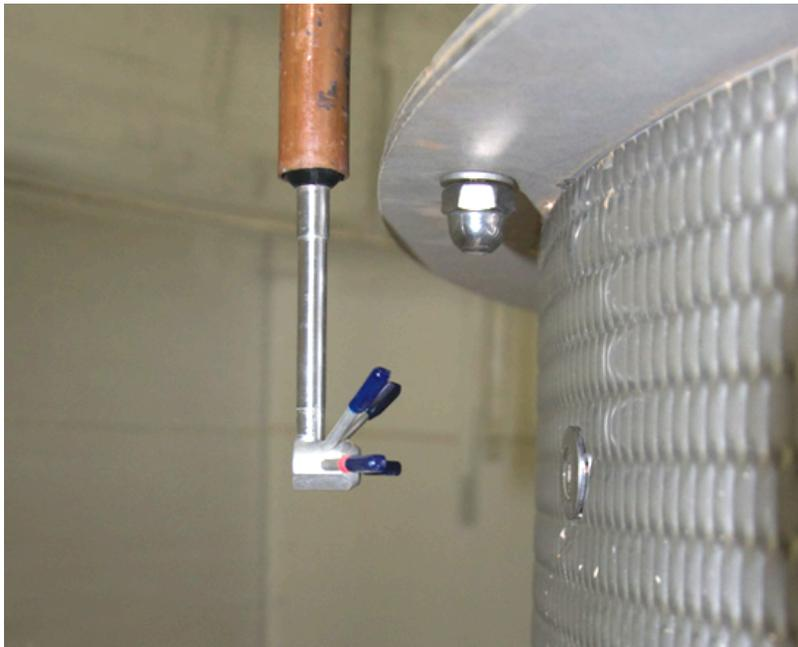
*Figure 80. Photographie de l'ADV à l'amont de la grille (vue de profil)*
