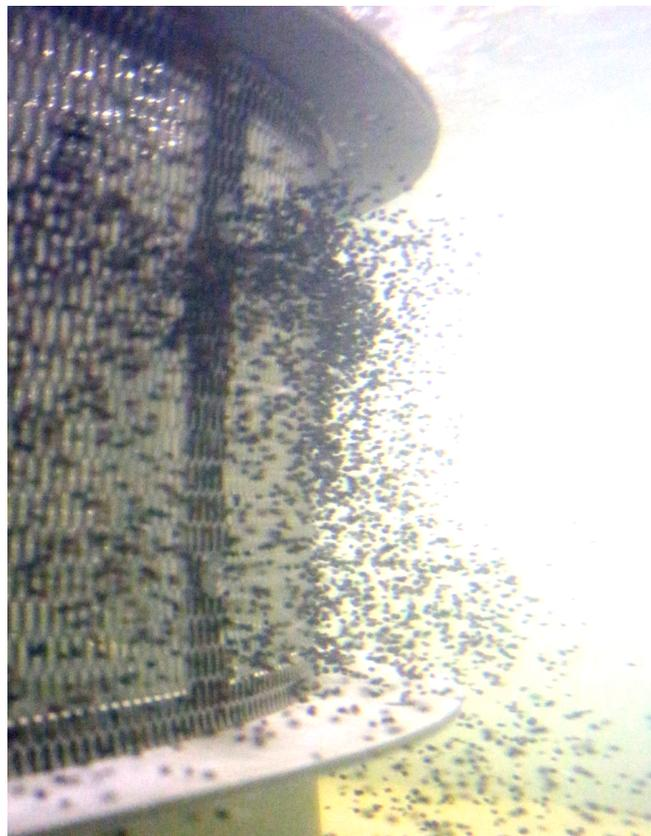
*Figure 94. Particules de polystyrol noir en circulation autour de la grille PM*
