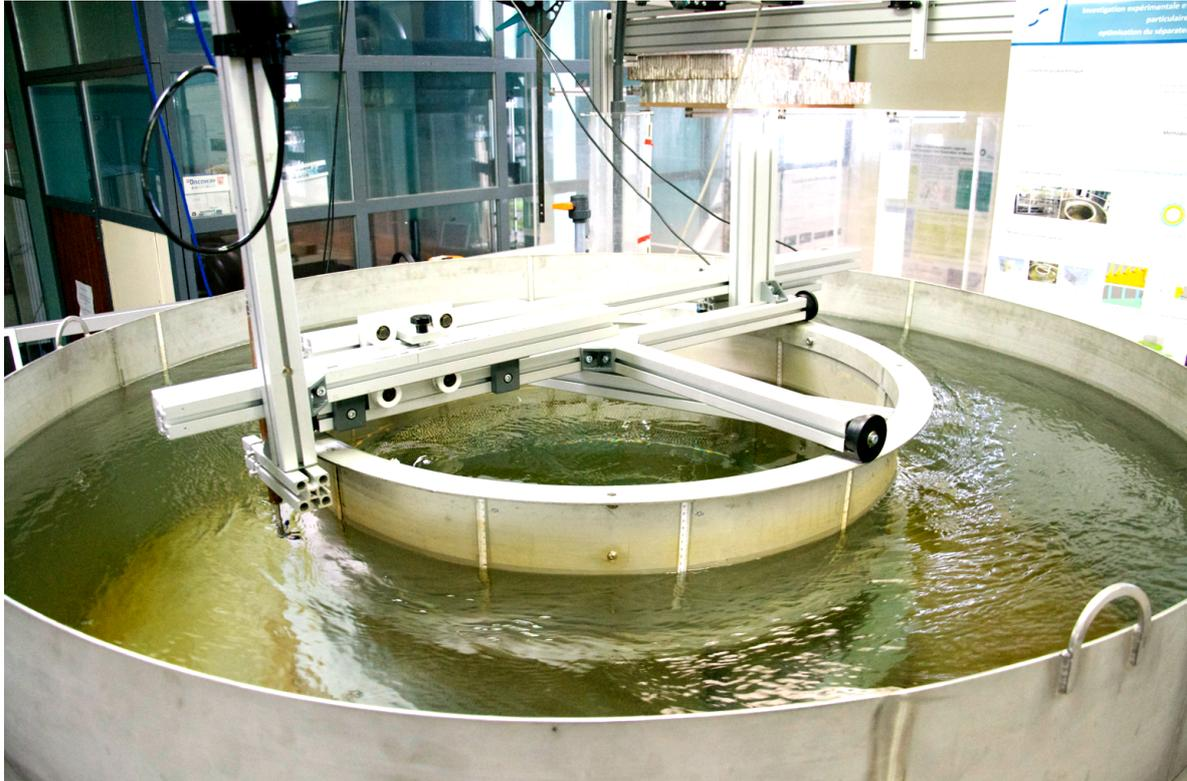
*Figure 73. Photographie de la surface libre pour un débit d'injection de 25 l/s*
