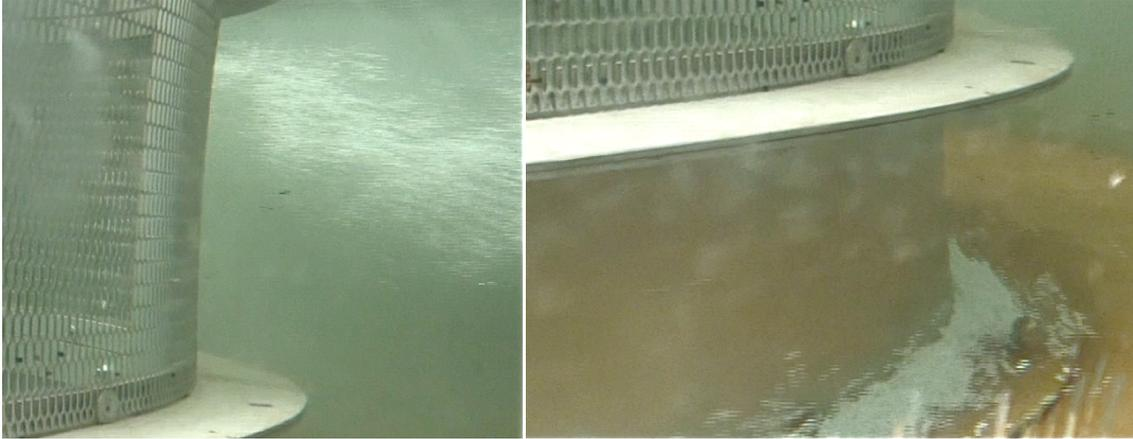
*Figure 95. Particules de PET après injection (à gauche) et après avoir effectué un tour (à droite)*
