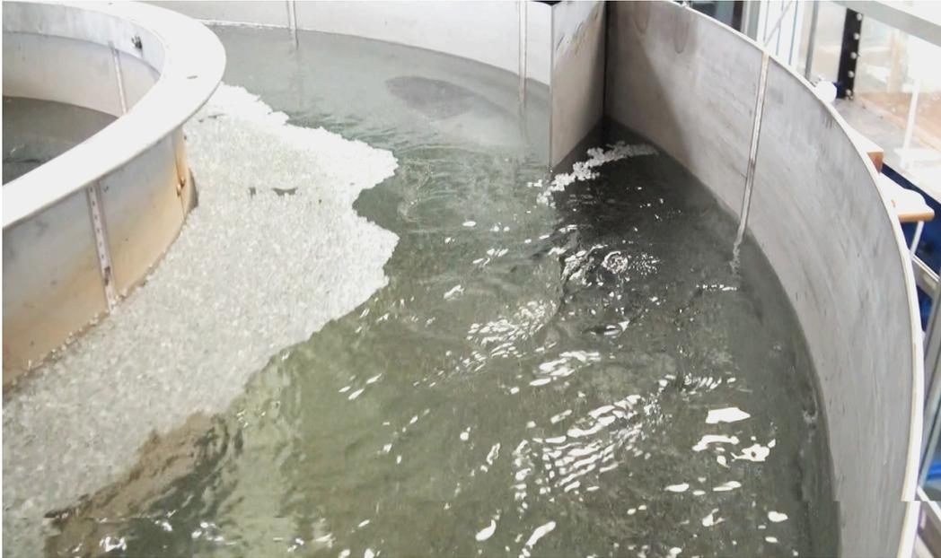
*Figure 41. Pilote expérimental en présence d'un déflecteur vertical sur la paroi extérieure*
