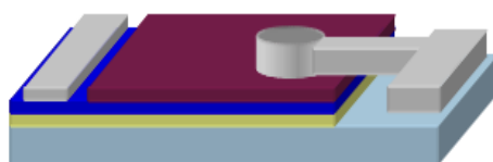
Figure 5.8 : Dépôt de la cathode et des plots de contact.
