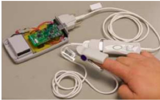
(a) Un nœud TelosB doté d'un capteur de pression sanguine [1].
