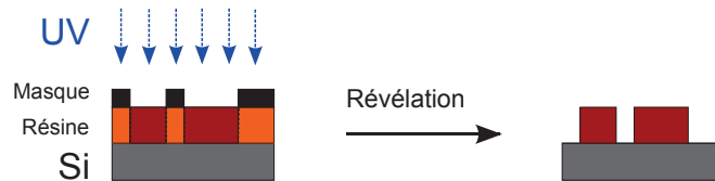
FIGURE 3.9 – Schéma illustrant l'étape de photolithographie. La résine déposée sur substrat de silicium est insolée à travers un masque souple. Elle réticule et devient insensible au révélateur.
