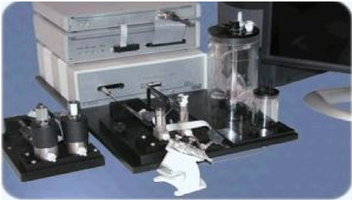
Figure 18 : Flexivent® : méthode d'oscillation forcée de la mesure de la fonction pulmonaire. Photographie du dispositif expérimental utilisé dans notre étude
