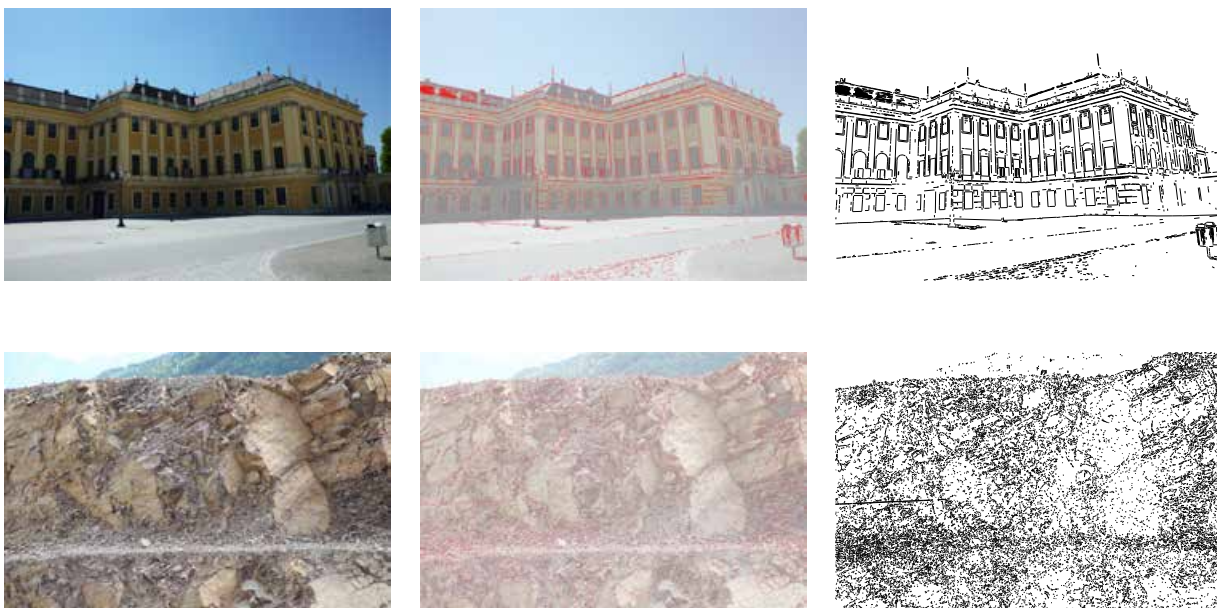
FIGURE III-1.10 – Exemples d'extraction de segments grâce à l'outil LSD - utilisation de l'algorithme de [Grompone von Gioi et al. , 2012] fourni par Image Processing On Line Journal (IPOL) : http://www.ipol.im/ ; En haut, illustration sur un objet architectural (château de Schönbrunn, Autriche); En bas, illustration sur une paroi rocheuse; De gauche à droite, images d'origine, superposition des segments détectés (rouge) sur l'image, et segments seuls.
