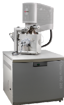
Figure 70. MEB environnemental Quanta (FEI).
