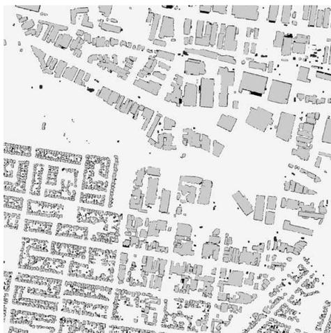
FIGURE 1.22 – Illustration de la méthode de Rottensteiner *et al.* (2005). En gris, les bâtiments correctement détectés ; en noir, les faux positifs.
