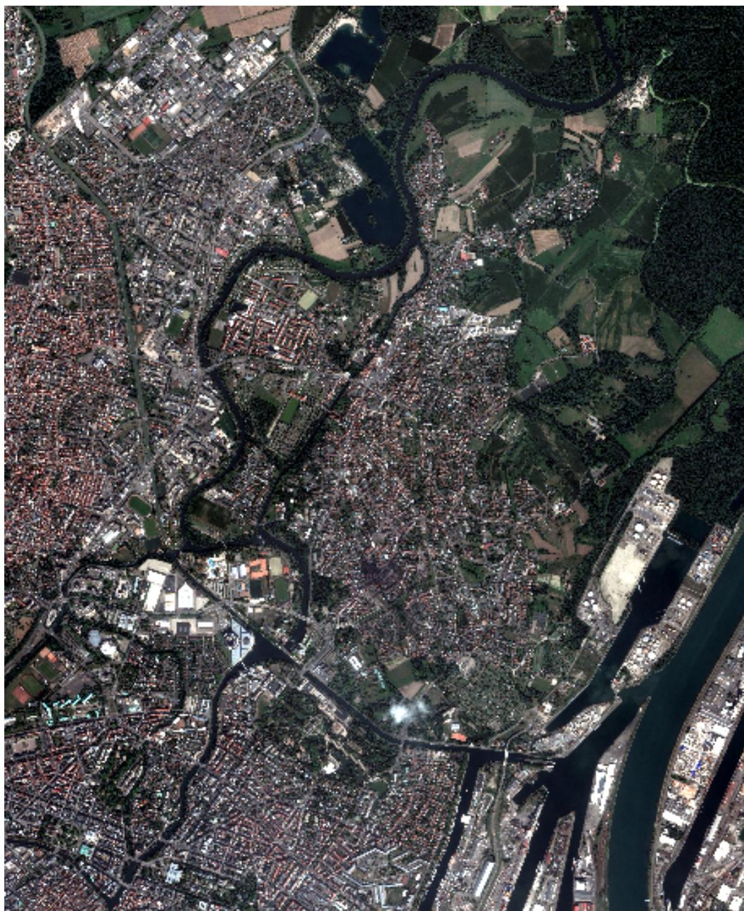
FIGURE A.3 – Cette image PLEIADES est une fusion Pan-MS d'une résolution de 0,5 mètres acquise en 2012, représentant la zone nord est de Strasbourg. L'image fait  $9211 \times 11275$  pixels et contient quatre bandes : rouge, vert, bleu et proche infrarouge.
