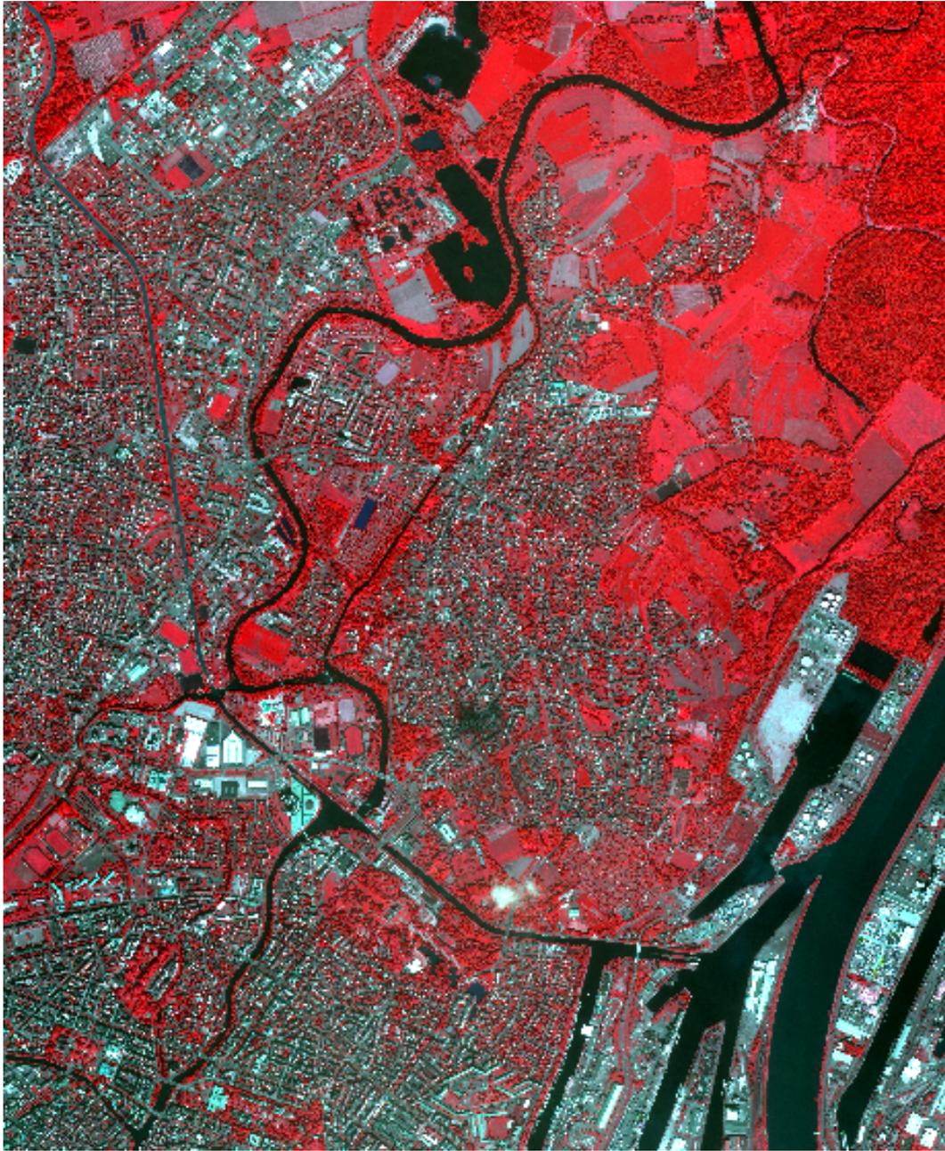
FIGURE A.4 – Cette image PLEIADES est une fusion Pan-MS d'une résolution de 0,5 mètres acquise en 2012, représentant la zone nord est de Strasbourg. L'image fait  $9211 \times 11275$  pixels et contient trois bandes : infrarouge, rouge et vert. Les couleurs sont rééchantillonnées en huit bits pour faciliter l'affichage.
