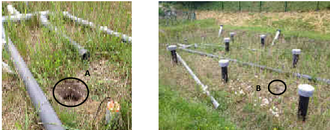
Figure 9-7. Points de prélèvement (en noir) des sols des filtres plantés de roseaux (exemple avec le filtre n°1, à gauche, proche d'une sortie de la rampe d'alimentation, à droite, éloigné d'une sortie de la rampe d'alimentation)
