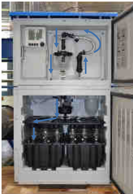
Figure 6-1. Circuit de l'eau dans le préleveur
