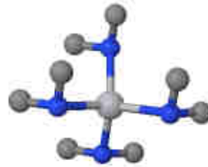
Figure II-29 : Représentation de la molécule de TDMAT
