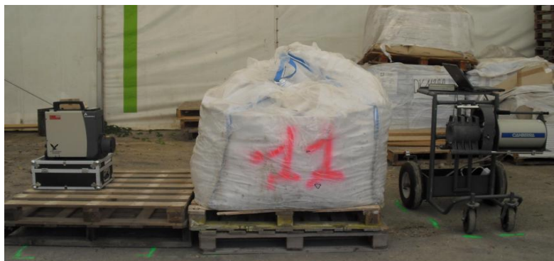
Figure IV-22 : Photographie du site de mesure : FALCON à gauche et ISOCS à droite du Big-Bag.
