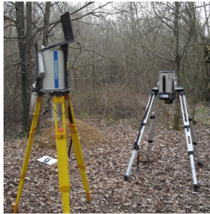
Figure IV-19 : Exemple d'un point de mesure zone boisée avec les deux détecteurs.
