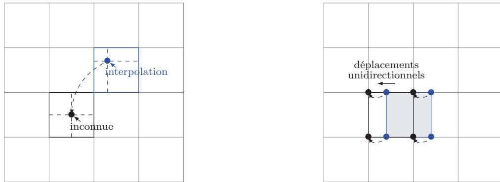
FIGURE 1.4: À gauche : méthode semi-lagrangienne ponctuelle en arrière ; à droite : méthode semi-lagrangienne conservative utilisée avec splitting directionnel.
