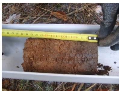
Figure II-8 : Carottage des 15 premiers centimètres du sol.
