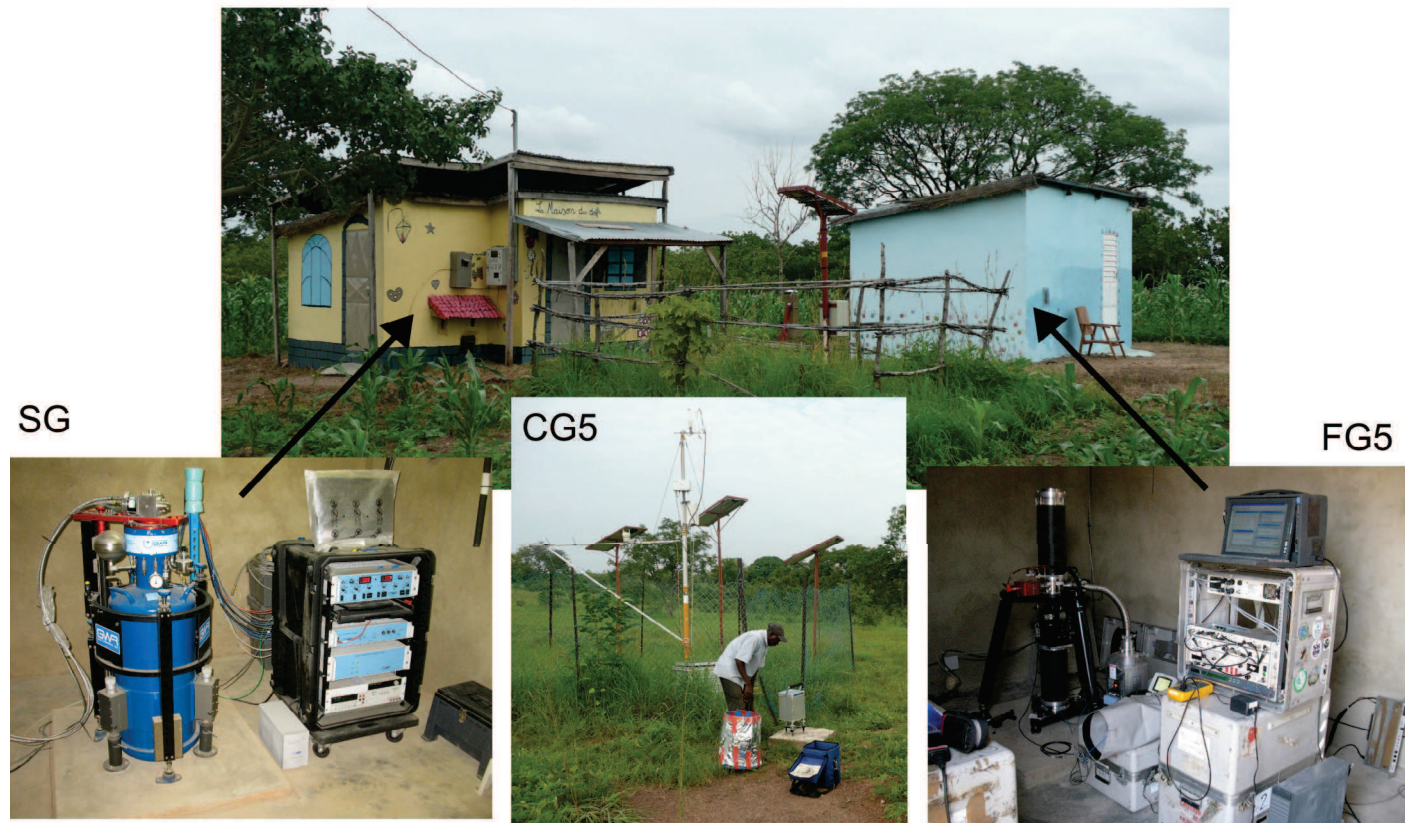
Figure V.3: les gravimètres de Nalohou : le gravimètre relatif supraconducteur (SG), le gravimètre relatif CG5 et le gravimètre absolu FG5.
