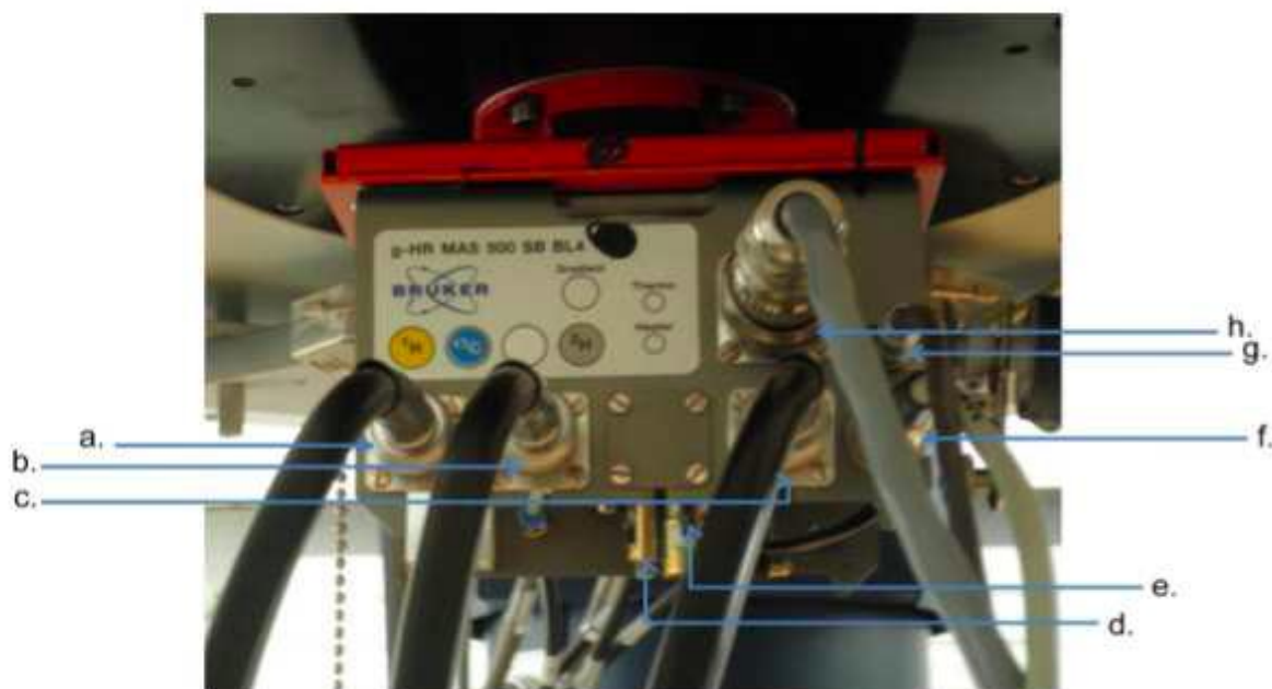
Figure 15. Partie connectique de la sonde HRMAS, (a) canal proton ^1\text{H} , (b) canal carbone ^{13}\text{C} , (c) canal deutérium ^2\text{H} , (d) réglage de l'angle magique, (e) réglage des antennes RF, (f) chauffage, (g) mesure de la température, (h) gradient (d'après M. Benhamed, Université de Strasbourg, 2012).
