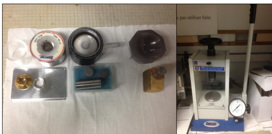
Figure 2.3.3. Matériels (moule, broyeur et presse) utilisés pour préparer une pastille de KBr pour l'analyse FTIR
