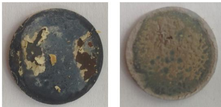
Figure 2.1.5. Délaminage du dépôt de Ca-P à cause de traitement thermique à 700 (à gauche) et 800°C (à droite)
