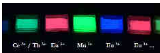
Figure 1.20 : Quelques exemples de cations métalliques utilisés pour marquer les billets de banque.
