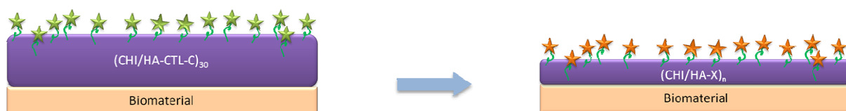
Figure 9 : Représentation schématique de l'ancien revêtement incluant la cateslytine comme peptide antimicrobien (à gauche) et du nouveau revêtement incluant le nouveau peptide à définir possédant de meilleures propriétés antimicrobiennes que la cateslytine et permettant ainsi d'élaborer un film multicouche avec un nombre de bicouches inférieur pour une même efficacité (à droite).
