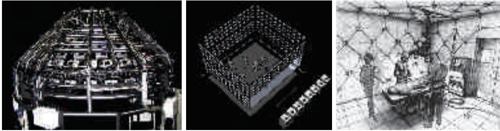
Figure 3.3 : Exemples de montage de centaines de caméras imaginés respectivement pour la numérisation d'objets culturels [Müller et al., 2005], pour des projets de réalité virtuelle [Vedula et al., 2005] ou de chirurgie/télé-conférence à base de réalité augmentée [Fuchs et al., 1994].
