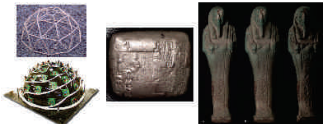
Figure 4.20 : De gauche à droite : dôme rigide d'acquisition ; exemple de reconstruction d'une pierre ré-éclairée ; reconstruction et ré-haussement de la texture résultante afin de visualiser les gravures. Illustrations issues de [Malzbender et al., 2001].
