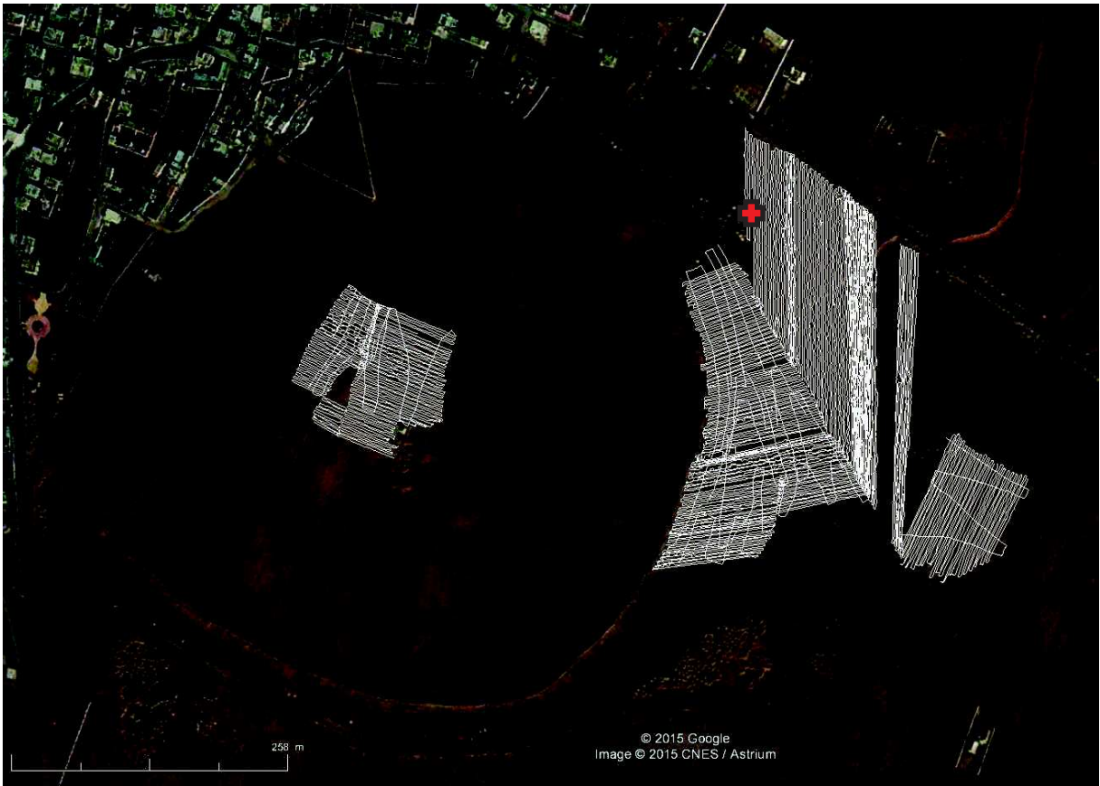
Figure 3.38 Routes suivies pour les cartographies magnétiques de l'EOST au site de Sh'airat, le point de calibration est indiqué par la croix rouge.
