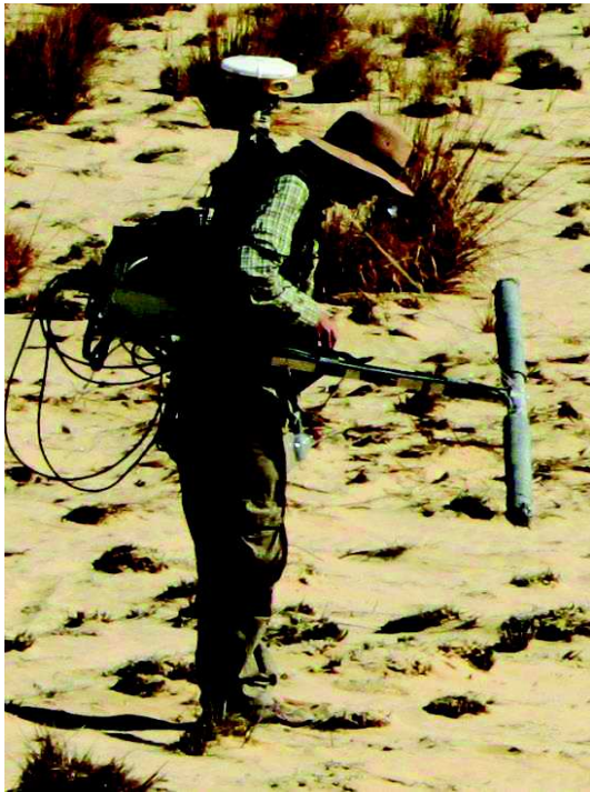
Figure 3.17 Système de perche version quatre capteurs type fluxgate.
