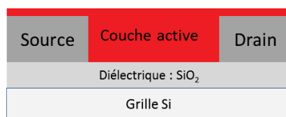
Figure 76 : architecture d'un transistor FET de type bottom gate-bottom contact.
