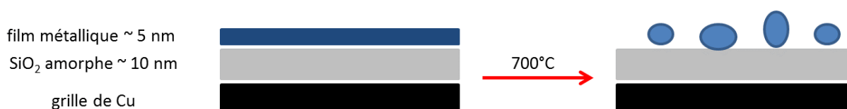
Figure 4.1 : Schéma représentatif de la formation, in-situ à haute température, des nanoparticules métalliques à partir du film initialement déposé sur la membrane du SiO 2 .
