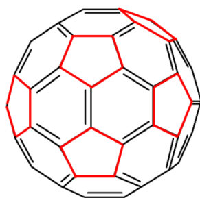
Figure 1.19 : Structure d'un fullerène C 60 .
