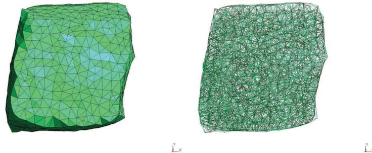
FIGURE 4.12 – Maillages surfacique (à gauche) et volumique (à droite) générés à partir de l'image TDM.
