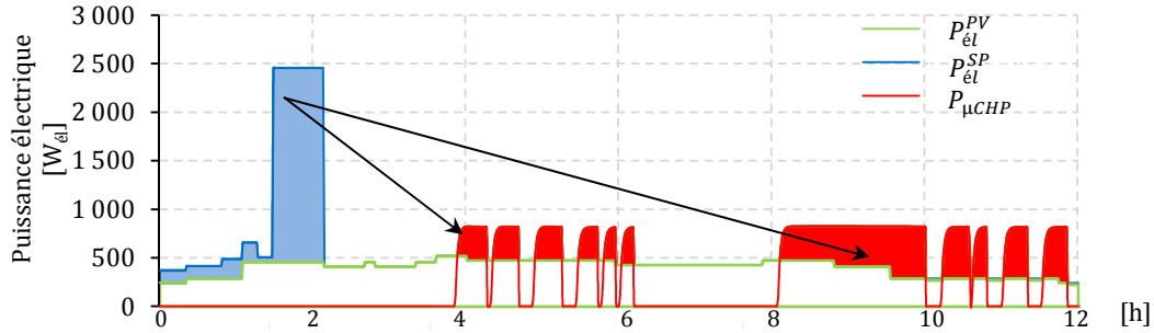
Fig. VI.52 – Report de charges électriques flexibles.
