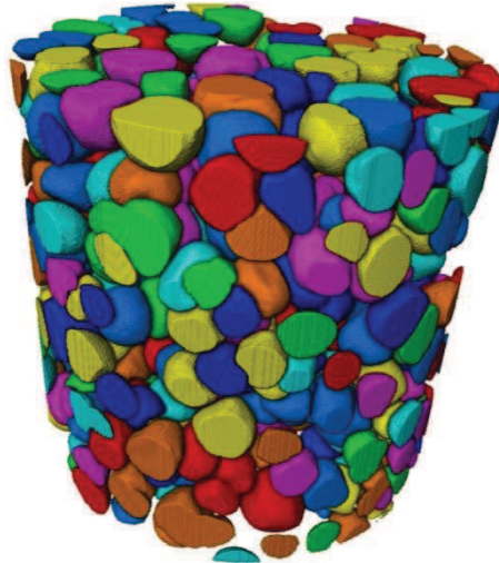
Figure 73: Modèle de microstructure réel testé (600 cellules)
