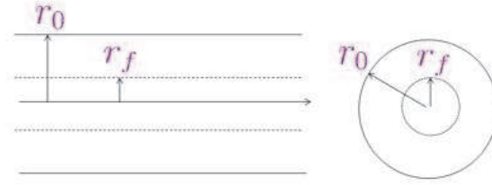
Figure 2.101: Définition des coordonnées utilisées pour le calcul de l'imbibition d'un cylindre infini.
