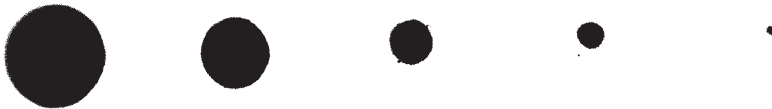
Figure 3.21: binarisation des photos de la figure 3.20 de l'imbibition d'un agrégat de diamètre 2\text{ mm} constitué de billes de silice de diamètre 8\ \mu\text{m} par le liquide polyurethane dans didp de viscosité 140\text{ Pa.s} .
