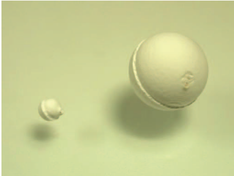
Figure 2.78: agrégats secs de rayon 1 \text{ mm} et 3.5 \text{ mm} constitués de billes de silice de diamètre 300 \text{ nm} . Les défauts de forme des agrégats induits par les défauts de forme des moules sont plus marqués pour les agrégats petits que les agrégats grands.
