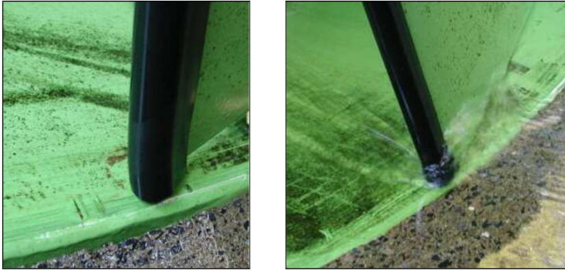
FIGURE 2.22 – Photo des protections antichocs pour la protection des poissons installées sur les premières pales d'une vis d'Archimède - Source : Kiebel et al. [2009]
