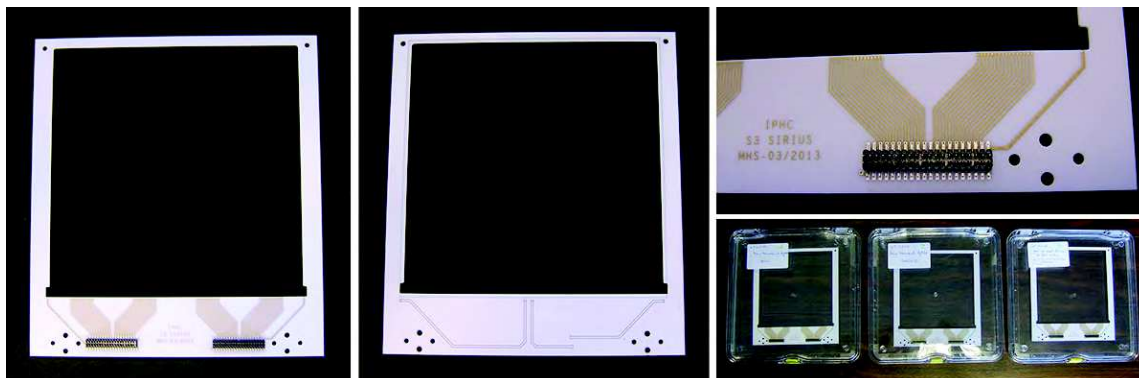
FIGURE 7.3 – Vue du cadre "2D" céramique. À gauche le côté "ohmique", au centre le côté "jonction". Sur la figure en haut à droite, on peut voir en détail le connecteur collé sur les pads AgPtPd (on y voit notamment certains pads à bonder qui brillent). En bas à droite on voit les 3 cadres montés, avant expédition à MICRON, dans leur boîte à tambour.
