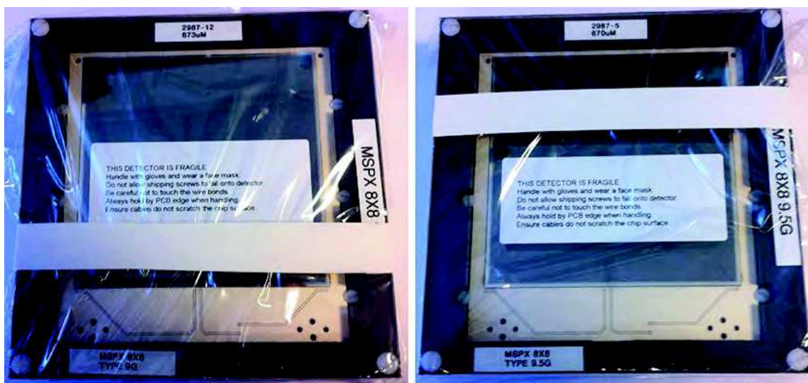
FIGURE 7.6 – Vues des détecteurs MSPX 8×8 référence 2987-12 (2D 12 ) et 2987-5 (2D 5 ) à la livraison dans leur emballage de transport.
