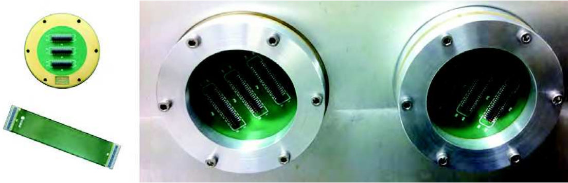
FIGURE 6.5 – Vue des passages à vide épais (5 mm) et limandes Kapton développées pour notre projet (à gauche) et des passages de signaux de l'intérieur à l'extérieur de la chambre montés sur le banc de test (à droite).
