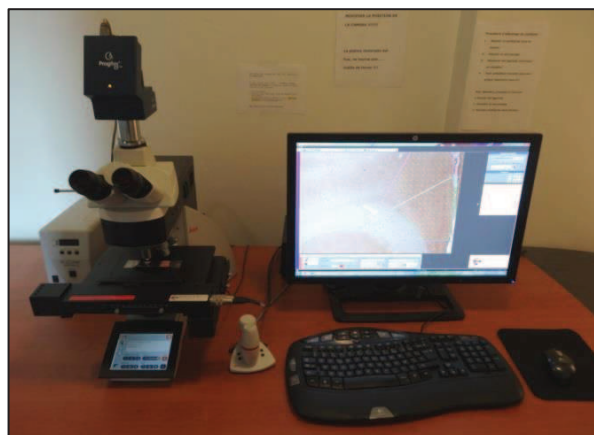
Figure 65. La station d'imagerie du laboratoire dédiée au comptage selon une approche stéréologique. Un microscope optique Leica doté d'une caméra numérique est relié à travers une carte contrôleur et numérique à un ordinateur d'où
