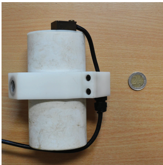
Figure 1.9 – Magnétomètre à protons. Modèle GSM-19 de GEM systems (Bruno Gavazzi).
