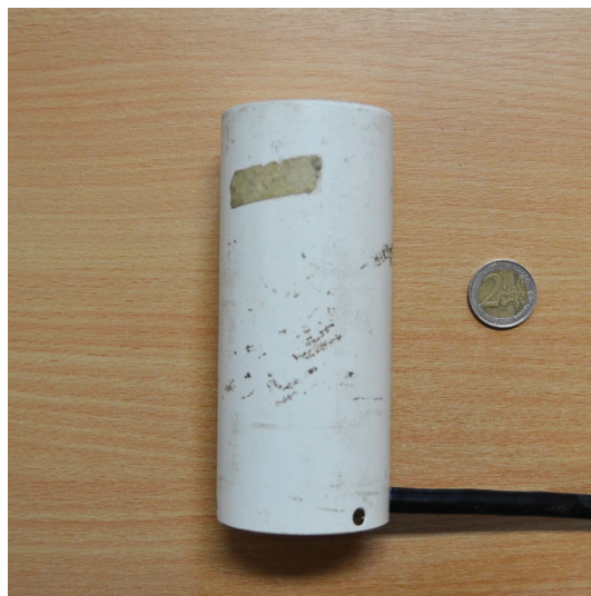
Figure 1.10 – Magnétomètre à pompe optique au césium. Modèle G-858 de Geometrics (Bruno Gavazzi).
