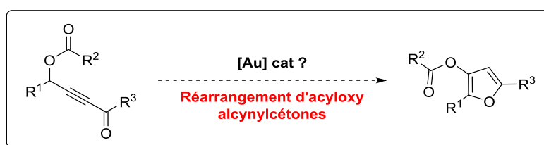
Schéma 136. Objectif d'exploration de la réactivité des acyloxy alcynylcétones
