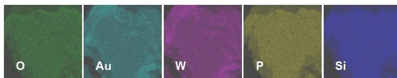
Schéma 61 : Cartographie EDX des éléments du catalyseur A
