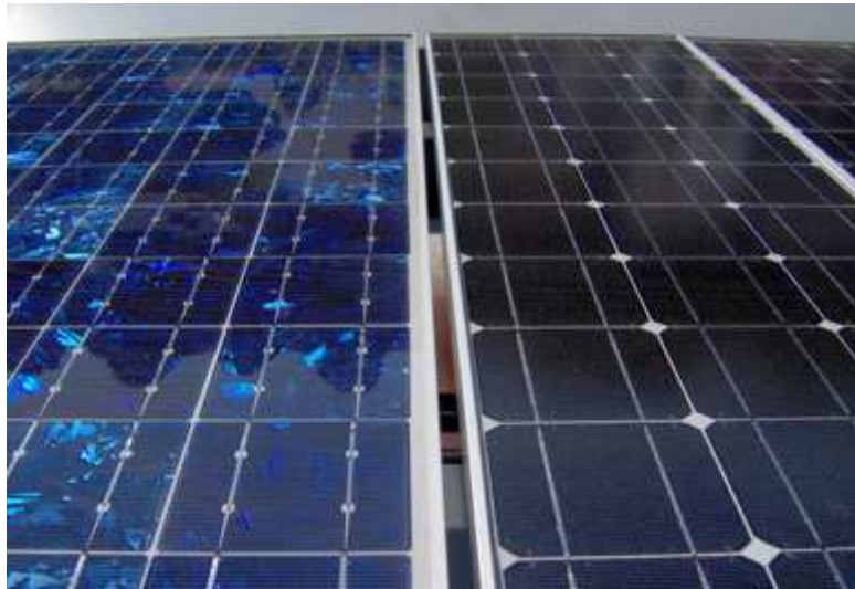
Figure 1.3. Panneaux solaires utilisant du silicium polycristallin (à gauche) et monocristallin (à droite).
