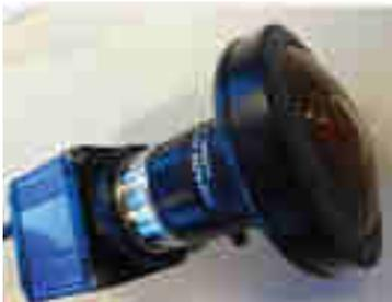
Figure 1 : Objectif *fish-eye* Fujinon fixé sur une caméra industrielle Matrix Vision
