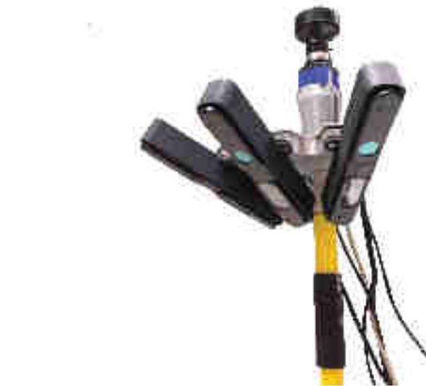
FIGURE 3.44 : Assemblage de l'ensemble des pôles de vision
