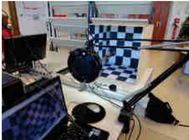
FIGURE 3.35 : Dispositif de prise de cliché en vue de la calibration [Vincent, 2013]
